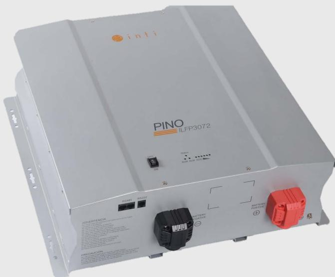
Pino de Inti es una batería Ión Litio libre de mantenimiento LiFePO4 con un rango diverso de capacidades nominales a 25,6Vdc y 51,2Vdc y con una vida útil de  $\geq 3\ 650$  ciclos a un 80% DOD y 25°C. El sistema customizado de carga de la batería con BMS inteligente integrado con protección de temperatura y comunicación tipo RS485 permite extender la vida útil de la batería.
